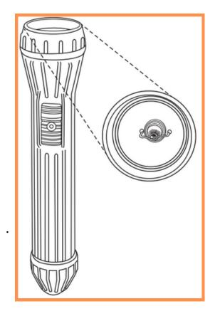
Este modelo aprobado de Fulton contiene un conjunto especial de resorte «disyuntor» que desconecta instantáneamente la bombilla de la batería en caso de rotura de la bombilla. Se evita una posible explosión ya que el filamento se desconecta instantáneamente, evitando un posible riesgo de chispa.
